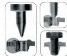
Bilder rechts: Beispiel für Fließ-Loch-Bohren. Wird in der Blechverarbeitung angewendet.
